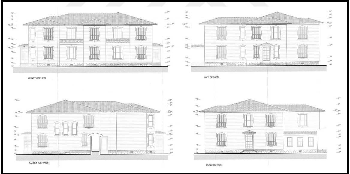
Şekil 3.283 Bahariye Mevlevîhânesi II. Restitüsyon Harem Yapısı Güney, Batı, Kuzey ve Doğu Cepheleri [121]
