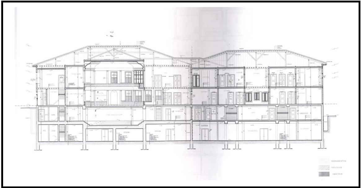
Şekil 3.201 Kasımpaşa Mevlevîhânesi Rekonstrüksiyon Kesit [121]
