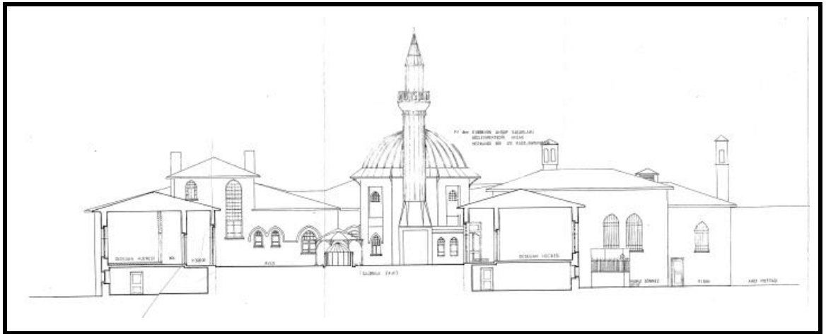
Şekil 3.127 Dedegan Hücreleri (Restitüsyon) A-A Kesiti [121]
